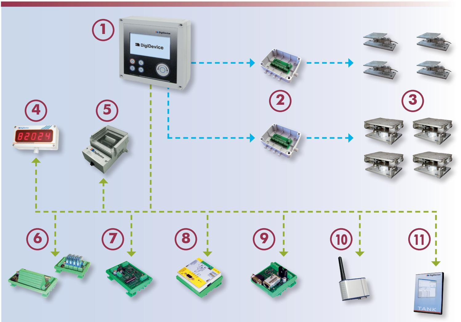
**1** **Indicateur de Poids WBOX TANK** disponibles pour un ou deux canaux de poids avec ou sans fonctions de dosage d'un poids affichable; dans la photo la version stand alone (version en CAISSON ÉTANCHE)
